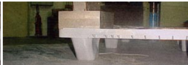
Foto 3 - Carga de colapso sobre apoio de canto
